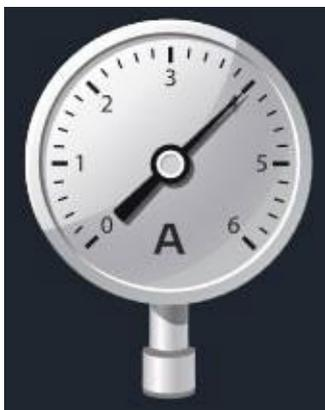
Рис. 16. Датчик абсолютного давления
