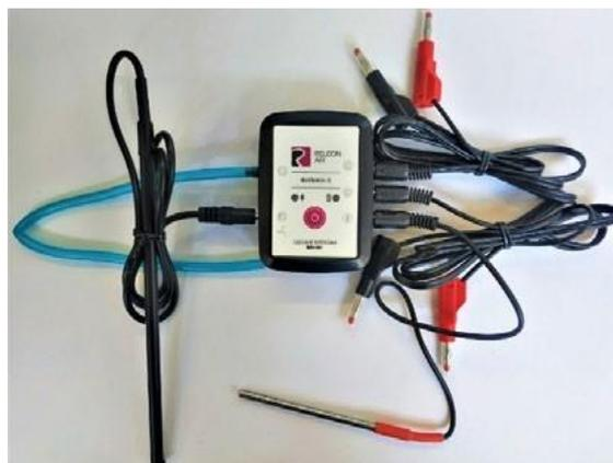
Рис. 9. Беспроводной мультидатчик Releon Air «Физика-5»
